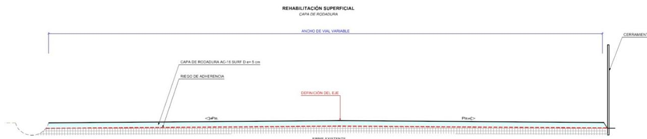
*Sección tipo de tramos con renovación superficial de firme*
