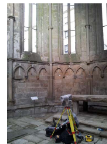
Figura 5.1. Equipo TLS dispuesto en el interior del ábside 3.
