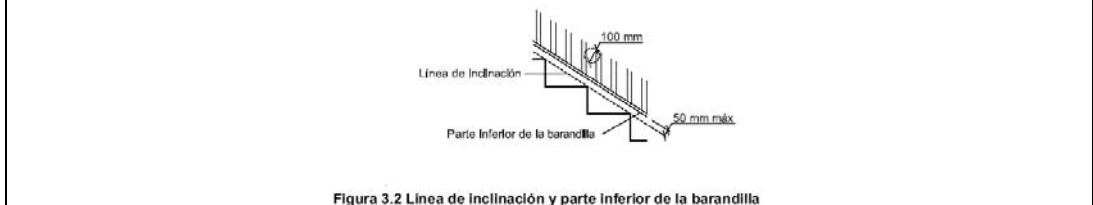
Figura 3.2 Línea de inclinación y parte inferior de la barandilla
