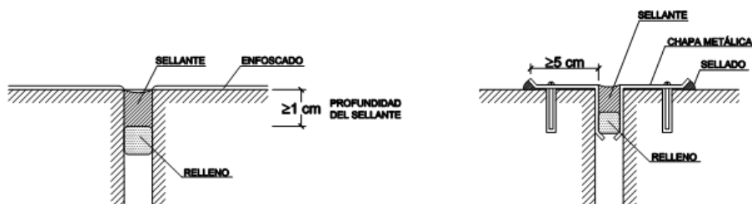
Figura 2.6 Ejemplos de juntas de dilatación
