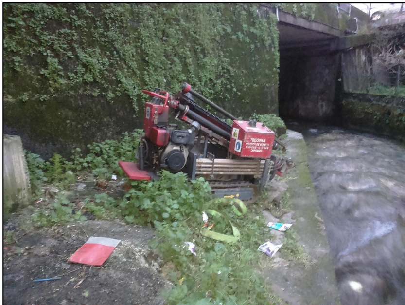
Vista del equipo de penetración dinámica en el punto P-1 / SP-1.
