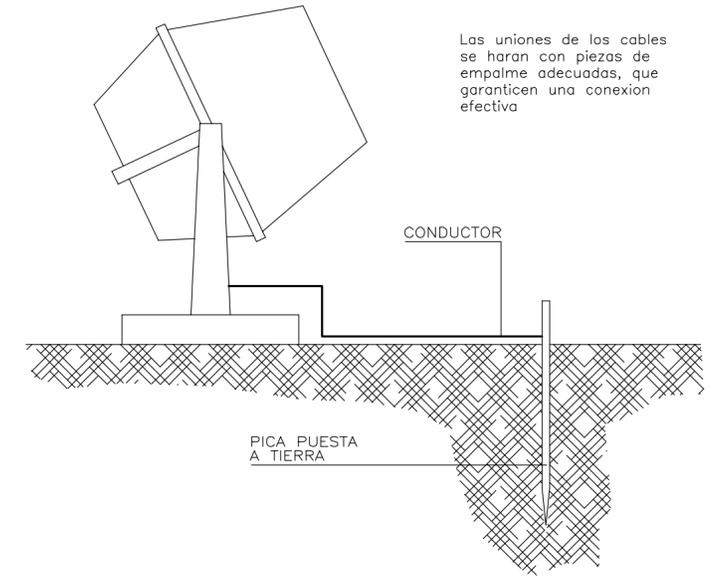
ESQUEMA ELÉCTRICO DE INSTALACIÓN PROVISIONAL DE OBRA
