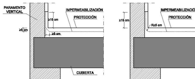
Para que el agua de las precipitaciones o la que se deslice por el paramento no se filtre por el remate superior de la impermeabilización, dicho remate debe realizarse de alguna de las formas siguientes o de cualquier otra que produzca el mismo efecto:
