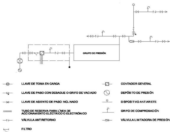
Figura 3.1 Esquema de red con contador general
